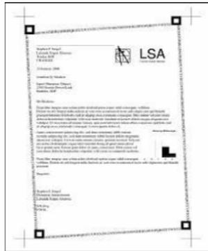
Figura 1 Documento di test utilizzato per **ISO/IEC19752**
