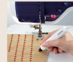
ぬい模様の位置や幅、ぬい終わりの位置まで、センサーペンを使ってあっという間に設定できます。設定したい位置をセンサーペンでタッチするだけの手軽さで正確なステッチが実現するので、これまで躊躇していた模様ステッチをふんだんに使った作品にも挑戦できます。
