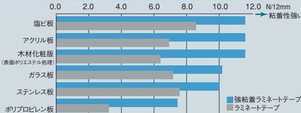
ブラザーTZeテープの通常ラミネートテープは、ほとんどの材質に対し十分な貼り付け性能があります。但し、一般的に粘着テープが付きにくいポリプロピレン板に対しては低い値を示していますが、この場合、強粘着ラミネートテープを使用していただくことにより、十分な貼り付け性能を発揮します。被着体の材質に応じて、強粘着ラミネートテープとの使い分けをお勧めします。
