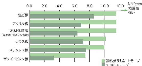
ブラザーTZテープの通常ラミネートテープは、ほとんどの材質に対し十分な貼り付け性能があります。但し、一般的に粘着テープが付きにくいポリプロピレン板に対しては低い値を示していますが、この場合、強粘着ラミネートテープを使用していただくことにより、十分な貼り付け性能を有します。被着体の材質に応じて、強粘着ラミネートテープとの使い分けをお勧めします。
