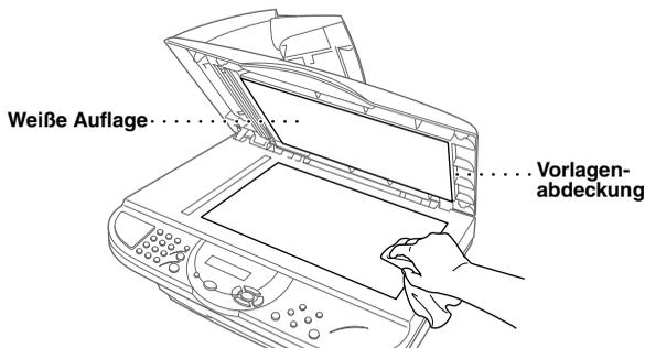
Reinigen Sie die weiße Rolle und den gegenüberliegenden Glasstreifen mit einem fusselfreien, mit Isopropylalkohol angefeuchteten Tuch.
