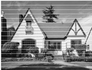
当打印头喷嘴堵塞时，打印样例如图所示。
