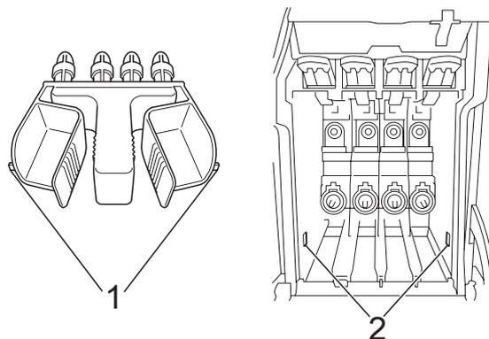
Wenn Sie den grünen Transportschutz nicht mehr finden, sollten Sie die Tintenpatronen vor dem Transport NICHT entfernen. Das Gerät darf nur mit dem grünen Transportschutz oder mit eingesetzten Tintenpatronen versandt werden. Der Versand ohne eingesetzte Tintenpatronen oder Transportschutz kann zu Schäden am Gerät und zum Verlust von Garantieansprüchen führen.
