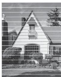
Si la boquilla del cabezal de impresión está obstruida, la prueba de impresión tendrá este aspecto.
