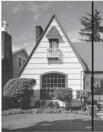
Si hay suciedad o corrector líquido en la tira de cristal, en la prueba de impresión aparecerá una línea vertical.
