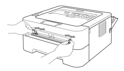
8 양손을 사용하여, A4 또는 레터 크기 용지 한 장을 용지의 위쪽 가장자리가 용지 공급 롤러에 닿을 때까지 수동 급지 슬롯에 넣으십시오. 장치가 용지를 안으로 끌어당기는 것이 느껴질 때까지 놓아 두십시오. 장치가 드럼 청소 과정을 시작합니다. 드럼 청소 과정 동안 Ready LED 가 점멸합니다.
