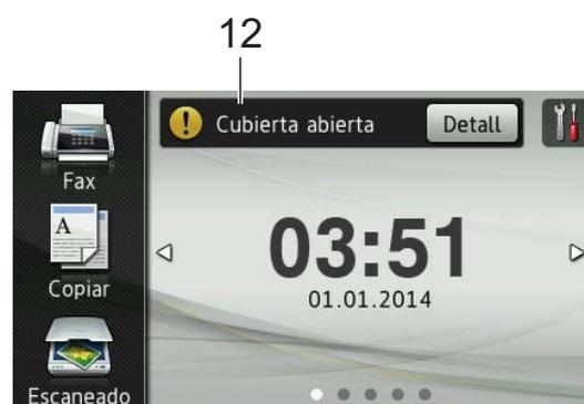
El icono de advertencia ! aparece cuando se genera un mensaje de error o de mantenimiento. Pulse **Detail** para visualizar el mensaje y, a continuación, pulse **X** para volver al modo preparado.
