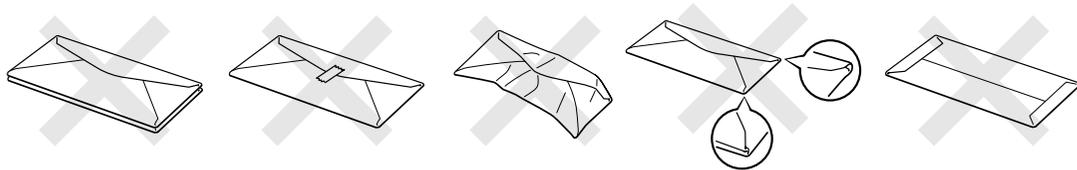
上記の種類の封筒を使用すると、本製品が故障する可能性があります。
