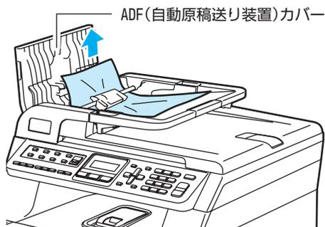
3 ADF（自動原稿送り装置）カバーを閉じる
