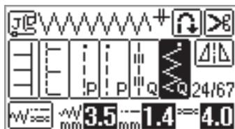
**7** ぬいながらスピードコントロールレバーを動かして振り幅を調節します。
