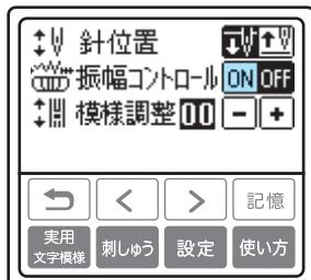
△ スピードコントロールレバーでジグザグの振り幅が変更できるようになります。
