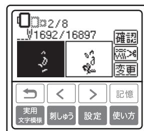
針数が表示されていないときは、[設定] (Setting key) を押して表示を切り替えます。[▼] (戻るキー) を押すと、もとの画面に戻ります。
