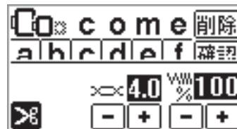
**削除** 自動糸切りを設定／解除します。設定されているときは反転表示されます。
