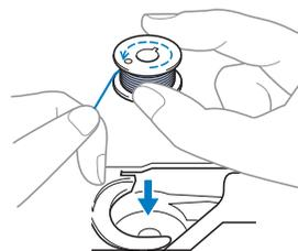
Wenn Sie die Spule so einsetzen, dass der Faden in die falsche Richtung abwickelt, wird mit der falschen Fadenspannung genäht.
