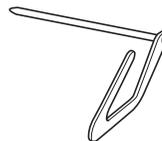
1 **Führen Sie den Stiel der Quiltführung in das Loch an der Rückseite des Stoffobertransports oder des Nähfußhalters.**
