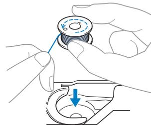
Wenn Sie die Spule so einsetzen, dass der Faden in die falsche Richtung abwickelt, wird mit der falschen Fadenspannung genäht.
