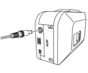
Wenn Sie den mitgelieferten Netzadapter (AD-24ES) verwenden, stecken Sie den kleinen Stecker des Adapterkabels in die Adapterbuchse an der Rückseite des P-touch-Beschriftungssystems. Stecken Sie den Netzadapter-Stecker in die nächstgelegene Steckdose.
