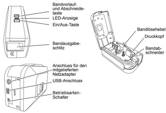
Der PT-2430PC hat zwei Betriebsarten - „EL“ und „E“. Der Betriebsartenschalter ist werkseitig für die Verwendung des P-touch Editor Lite voreingestellt (EL). Zur Verwendung des E-Betriebs müssen Sie den P-touch Editor 5.0, eine erweiterte Anwendung zum Erstellen von Beschriftungen, und die erforderlichen Treiber von der beiliegenden CD-ROM installieren. Weitere Informationen zur Installation des P-touch Editor 5.0 finden Sie unter „P-touch Editor 5.0 starten“ weiter unten.
