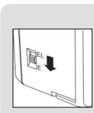
Bringen Sie den Betriebsartenschalter an der Rückseite des P-touch in die „E“-Position, bevor Sie das USB-Kabel anschließen.
