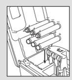
Wenn Sie den P-touch mit Batterien verwenden möchten, legen Sie sechs neue Alkalibatterien (AA, LR6) ein und vergewissern Sie sich, dass die Pole der Batterien in die richtige Richtung zeigen. Ersetzen Sie immer alle sechs Batterien durch neue Batterien.
