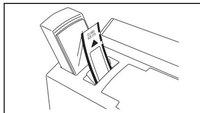
Per un inceppamento a livello del vano del nastro a inchiostro (sul display appare il messaggio "REMOVE LABEL 1", "REMOVE LABEL 2" o "REMOVE LABEL 3"):
