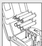
通过电池使用普贴趣标签机时，请插入 6 节新 5 号碱性电池 (LR06)，确定电极指向正确。使用新电池务必同时更换所有 6 节电池。
