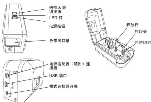
PT-2430PC 有两种模式选择器设置——“EL”和“E”。模式选择器开关在工厂预设为 EL 模式，配合 P-touch Editor Lite 使用。对于 E 模式，则需要从随附的光盘安装更高级的标签软件 P-touch Editor 5.0 和相应型号的驱动程序。有关如何安装 P-touch Editor 5.0 的详细信息，请参阅下面的“启动 P-touch Editor 5.0”。
