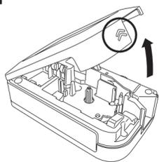
确认普贴趣标签机关机，在按住机盖“<<”区域的同时，如上图箭头所示打开机盖。
