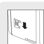
连接 USB 数据线之前，将普贴趣标签机背面的模式选择器开关切换到“E”位置。
