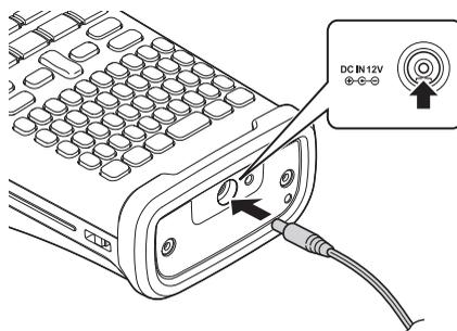
**1** Enchufe el cable de alimentación del adaptador de CA en el conector DC IN 12V del sistema de rotulado P-touch.
