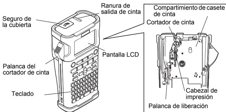
⚡ Cuando se envía desde la fábrica, la pantalla LCD está cubierta con una lámina protectora para evitar daños. Quite esta lámina antes de utilizar el P-touch.
