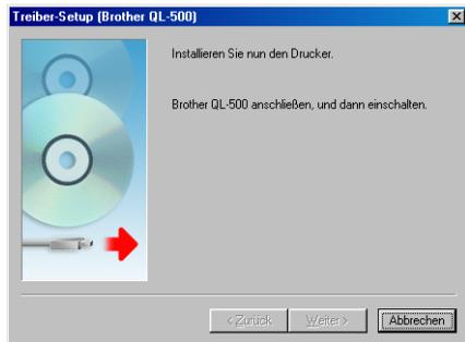
**8.** Wenn im Treiber-Setup-Dialogfeld die Aufforderung zum Anschließen des QL-500/550 erscheint, schließen Sie das USB-Kabel am USB-Anschluss an der Rückseite des QL-500/550 an.
