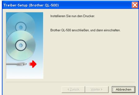
**8. Wenn im Treiber-Setup-Dialogfeld die Aufforderung zum Anschließen des QL-500/550 erscheint, schließen Sie das USB-Kabel am USB-Anschluss an der Rückseite des QL-500/550 an.**
