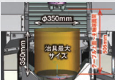
▲従来モデル比約1.4倍に拡大した加工の治具エリア(A軸0°)
