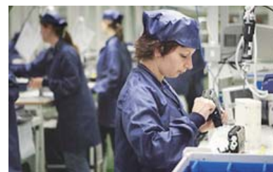
ブラザーインダストリーズ(スロバキア)でのトナーカートリッジ検査
