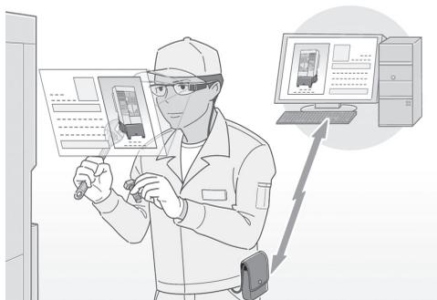
セル生産における多品種少量生産の大型機器など、複雑な機械の組立作業をサポートします。本製品はヘッドマウント、かつシースルー型で実際の視野に重ねて画面を確認できることから、一般的なディスプレイや紙などでマニュアルを確認する場合と比べ、ディスプレイまでの移動時間を短縮できるほか、情報を確認するために視野を移動させる必要がなく、作業効率の向上やミスの防止につながります。
