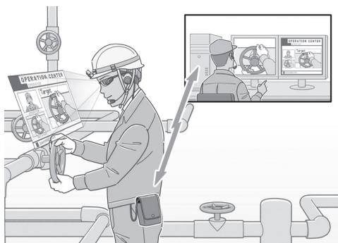
遠隔地から修理・メンテナンス作業等をサポートします。通信機能を有する端末に本製品とカメラ、ヘッドセット\*を接続し、作業現場の映像・音声情報を遠隔地のエキスパートに伝達することで、最適な情報を本製品のディスプレイに表示し、作業者は複雑な保守作業でも遠隔指示を受けながら両手を使って行うことができます。作業を録画して記録として残すことも可能です。
