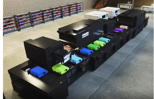
ガーメントプリンターの自動化ライン「Digitalline」のイメージ
