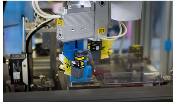
インクカートリッジの再生工程における自動化ライン
