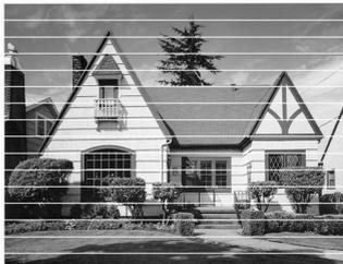
Lorsqu'une buse de la tête d'encre est encrassée, l'échantillon ressemble à celui illustré ci-dessus.
