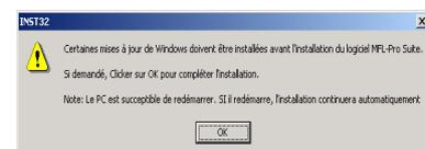
Si l'installation est interrompue, rouvrez le menu d'installation en cliquant deux fois sur le programme **setup.exe** dans le dossier racine sur le CD-ROM. Ensuite, reprenez l'installation à partir de l'étape 4.
