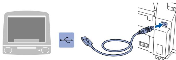
**Veillez à ne pas connecter le MFC au port USB du clavier ni à un concentrateur USB non alimenté.**
