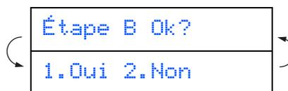
Examinez les essais d'impression à 600 PPP et à 1200 PPP pour vérifier si la qualité du bloc n° 5 se rapproche le plus possible de celle de l'échantillon type « OK » (n° 0). Appuyez sur **1** si la qualité du bloc n° 5 est satisfaisant.
