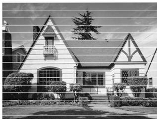
Si la boquilla del cabezal de tinta está obstruida, la prueba de impresión tendrá este aspecto.
