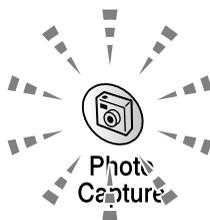
**⚠** NON staccare il cavo elettrico e non estrarre la scheda di memoria dall'apposita unità (slot) mentre l'apparecchio sta eseguendo la lettura o la scrittura della scheda (il tasto **PhotoCapture** lampeggia). **Altrimenti si può causare la perdita di dati o danneggiare la scheda.**
