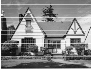
Horizontale Streifen durch verstopfte Tintendüse(n)
