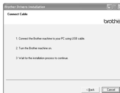
**Étape 5.** **Raccordez l'appareil à votre PC avec le câble parallèle ou USB.**
