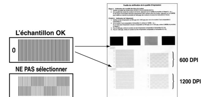
Si un autre numéro d'impression d'essai est plus proche pour 600PPP ou 1200PPP, appuyez sur **2 (NON)** pour le sélectionner.
