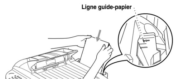
**B.** Appuyez sur le guide et faites-le glisser jusqu'à la position correspondant à la largeur du papier.
