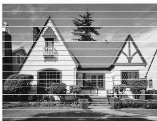
Lorsqu'une buse de tête d'encre est colmatée, voici à quoi ressemble la sortie imprimée.
