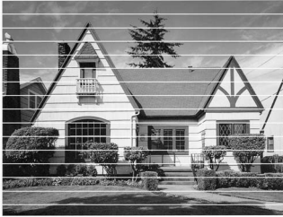
Horizontale Streifen durch verstopfte Tintendüse(n)
