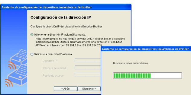
**El servidor de impresión inalámbrico NC-7100w admite el protocolo Direccionamiento automático de direcciones IP privadas (APIPA). Si no hay un servidor DHCP disponible, el servidor de impresión NC-7100w asignará automáticamente una dirección IP del intervalo 169.254.1.0 a 169.254.254.255.**
