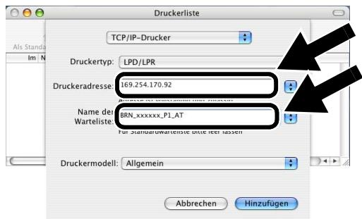
TCP/IP-Adressen können Sie der Netzwerkkonfigurationsseite entnehmen. Nähere Informationen zum Drucken der Netzwerkkonfigurationsseite finden Sie in der Installationsanleitung.
