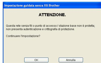
**10** Nella configurazione della periferica senza fili Brother, è necessario accertarsi che sia configurata in base alle impostazioni di autenticazione e crittografia della rete senza fili esistente. Se la rete è configurata per l'autenticazione e la crittografia, scegliere **Metodo di autenticazione** e **Modalità di crittografia** dai menu a discesa in ciascuna casella di impostazione. Immettere quindi la **Chiave di rete** e fare clic su **Avanti**.
