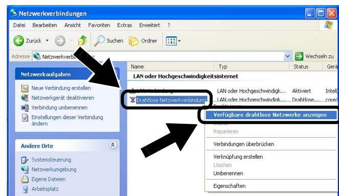
**4 Ihr Brother Wireless PrintServer NC-7100w wird im Feld Verfügbare drahtlose Netzwerke: angezeigt. Markieren Sie SETUP und aktivieren Sie das Kontrollkästchen Verbindungsherstellung mit dem .... Klicken Sie auf Verbinden.**
