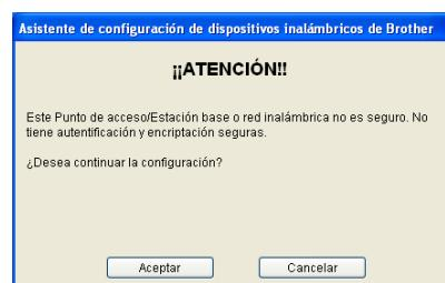
**10** Cuando configure su dispositivo inalámbrico Brother, debe estar seguro de que está configurado para coincidir con los parámetros de autentificación y encriptación de la red inalámbrica de que se dispone. Si la red está configurada para autentificación y encriptación, seleccione el **Método de autentificación** y el **Modo de encriptación** en las listas desplegables de cada opción. A continuación, introduzca la **Clave de red** y haga clic en **Siguiente**.
