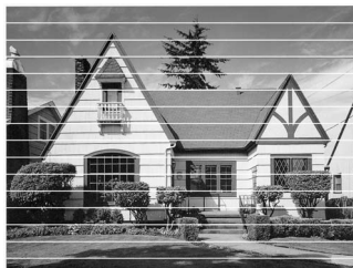
Horizontale Streifen durch verstopfte Tintendüse(n)
