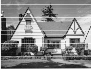
Horizontale Streifen durch verstopfte Tintendüse(n)
