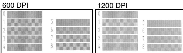
Si un autre numéro d'impression d'essai donne un meilleur résultat pour 600 ppp ou 1200 ppp, appuyez sur la touche (2) pour sélectionner NON et passer à l'étape 2.
