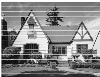
Wanneer de spuitmondjes van de inktkop zijn verstopt, dan ziet het afdrukvoorbeeld er zo uit.
