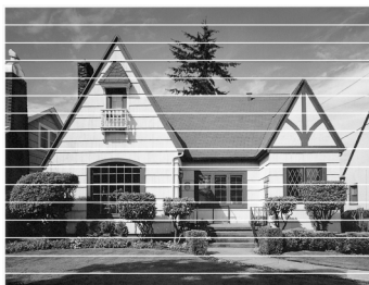
Horizontale Streifen durch verstopfte Tintendüse(n)
