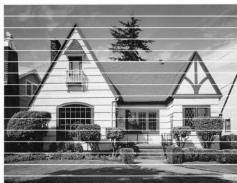
Cuando una boquilla de tinta se obtura, la muestra impresa sale así.
