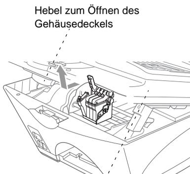
Hebel zum Öffnen des Gehäusedeckels
