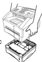
**B.** Branchez le câble modulaire du bac inférieur dans la prise modulaire de l'appareil.
