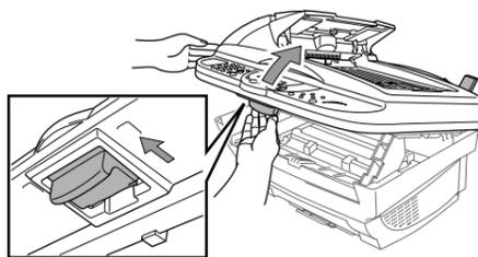
**C.** Fassen Sie die Trommeleinheit an den beiden Griffaschen und setzen Sie sie in das Gerät ein.
