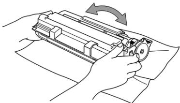
**B.** Öffnen Sie den Gehäusedeckel, indem Sie den Hebel am Gehäusedeckel zu sich ziehen.
