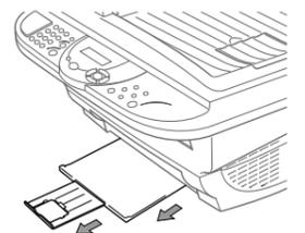
**C.** Zur Verwendung von A4-Papier klappen Sie den Papierstopper in der Verlängerung der Ablage aus.
