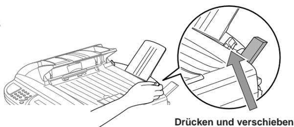
**C.** Halten Sie den Papierhebel nach unten gedrückt und legen Sie den Papierstapel mit der zu bedruckenden Seite nach unten in den Schacht ein. Achten Sie darauf, dass der Stapel die Markierung im Papierschacht nicht überschreitet. Es können ca. 200 Blatt oder 10 Umschläge eingelegt werden.
