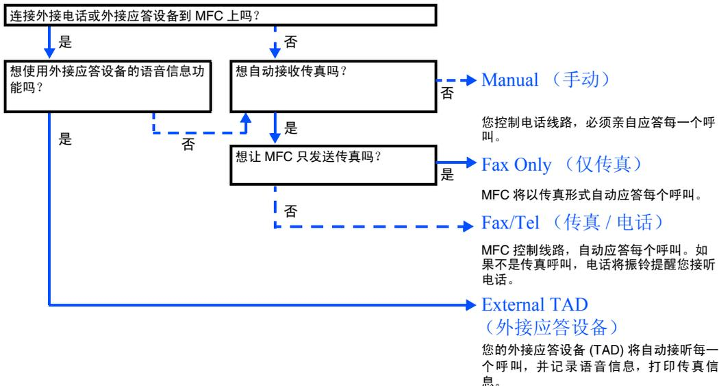
四种接收模式：Fax Only (仅传真)、Fax/Tel (传真/电话)、Manual (手动) 和 External TAD (外接应答设备)。
