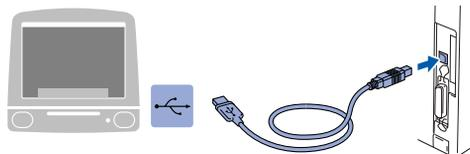
**请勿将 MFC 连接到键盘上的 USB 端口和无源的 USB 集线器上。**
