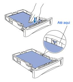
5 Coloque a gaveta de papel firmemente para trás no aparelho e abra o suporte do papel antes de utilizar o aparelho.
