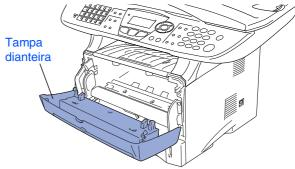
2 Retire a estrutura do cilindro. Remova as peças de protecção.
