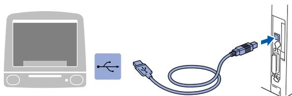
**No conecte el equipo MFC al puerto USB de un teclado ni a un hub USB sin alimentación eléctrica.**
