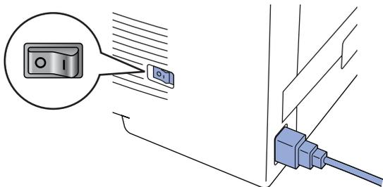
2 Enchufe el cable de alimentación CA a la toma de red. Encienda el equipo accionando el interruptor de encendido.
