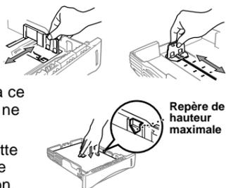
**D.** Faites coulisser la cassette dans l'appareil jusqu'à ce qu'elle se loge en position.
