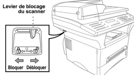
ⓘ Si le message VERIF.SCAN VEROU s'affiche à l'écran, vérifiez que le levier est bien en position de déverrouillage et appuyez sur **Arrêt/Sortie**.
