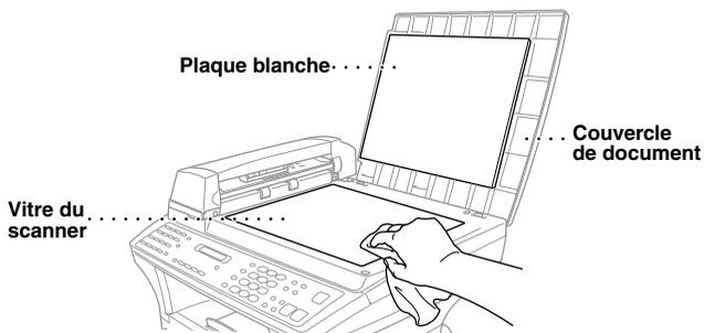
Soulevez le chargeur. Nettoyez la barre blanche et la bande vitrée sous la barre avec un chiffon non pelucheux imbibé d'alcool dénaturé.
