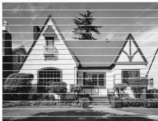
Si la boquilla del cabezal de impresora está obstruida, la prueba de impresión tendrá este aspecto.
