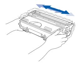
Empurre a estrutura do cilindro para o aparelho (até ficar encaixado no lugar).
