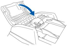
Instalar a estrutura do cilindro
